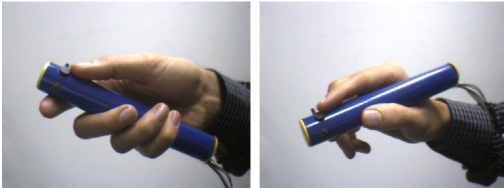
Abb. 4.1: Der Flystick: power grasp (links) und precision grasp (rechts)
