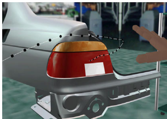
Abb. 2.7: Erzeugen eines Ausbaupfades in VR
